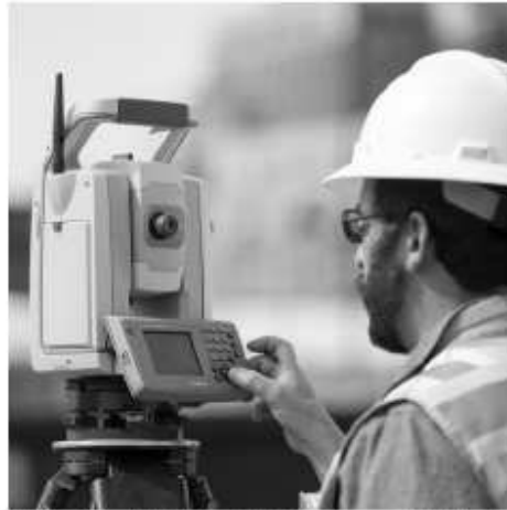
1. kép Trimble S5 mérőállomás munka közben
